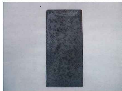
塩水噴霧試験後（500時間）の試験片
