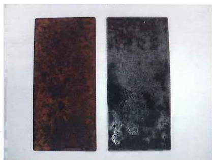
鍍鋼板とフェリックス117 塗布品（3種ケレン）
